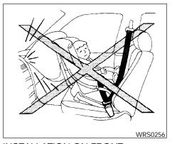
INSTALLATION ON FRONT PASSENGER SEAT OUTBOARD **POSITION**
